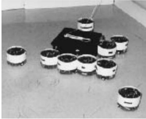
Figure 2-2 : tâche coopérative de transport d'objets par un groupe de robots mobiles
